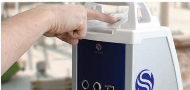
сканер оборудован одной много-функциональной кнопкой для управления системой.
