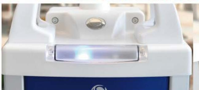
Светодиодная панель показывает состояние сканера (зарядку батареи либо процесс сканирования).
