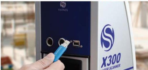
Используется три порта: 1. GPS соединения, 2. USB для скачивания данных, 3. Порт внешнего питания и передачи данных Ethernet.
